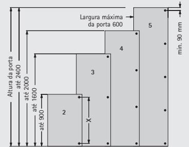
Valores de referência para chapas de 15mm de espessura e densidade 750kg/m<sup>3</sup> podendo variar conforme instalação no móvel.
