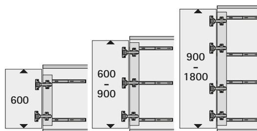
Altura da porta = altura interna do móvel - 6 mm
